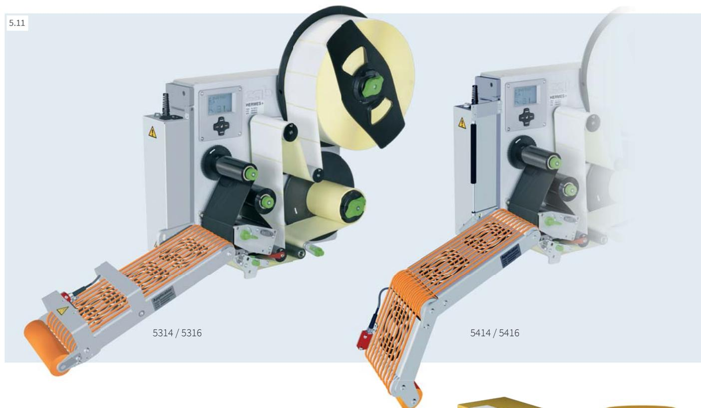
L'applicateur à déroulement par convoyage est positionné devant l'arête de pré-découlement. L'étiquette imprimée est transportée par une courroie en position de pré-découlement puis appliquée sur l'emballage grâce à un signal externe.
